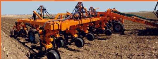
Для прямого посева, для посева по классической и минимальной технологии. Предназначен для посева зерновых и масляничных культур. Независимое копирование рельефа поля каждым сошником предоставляет возможность быстрой регулировки глубины посева по всем сошникам в диапазоне от 2 до 20 см.
