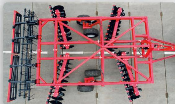
Применяется для основной обработки почвы под зерновые, кормовые и технические культуры на различных типах почв.
