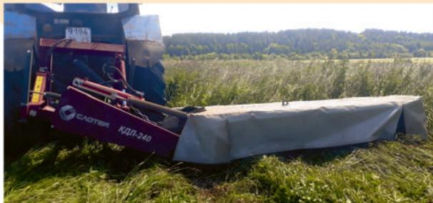
**Косилки дисковые с шириной захвата 2,5 и 2,9 метров**
