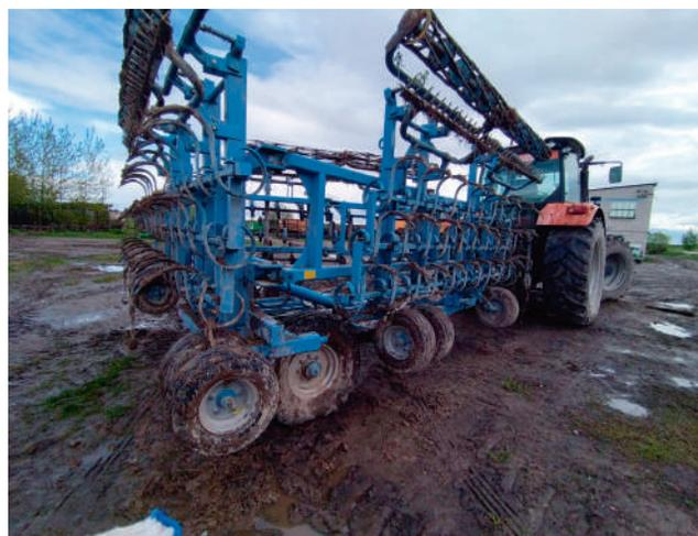
Рисунок 13 – Культиватор КБМ-10.8П «Ярославич» укомплектован серийными и опытными лапами и подготовлен к работе
