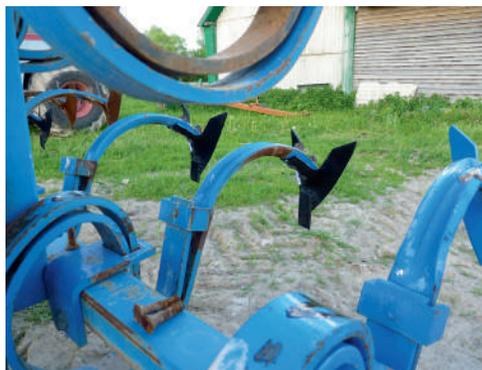
Рисунок 12 – Культиватор КБМ-8П укомплектован серийными и опытными лапами и подготовлен к работе
