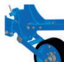
Прикатывающее колесо имеет ступенчатую регулировку и шину атмосферного давления.
