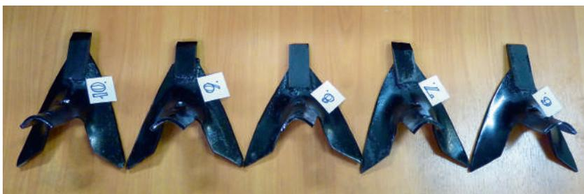
Рисунок 11 – Партия восстановленных и упрочненных стрельчатых лап для эксплуатационных испытаний
