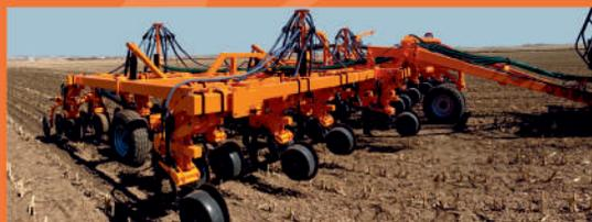
Для прямого посева, для посева по классической и минимальной технологии. Предназначен для посева зерновых и масличных культур. Независимое копирование рельефа поля каждым сошником предоставляет возможность быстрой регулировки глубины посева по всем сошникам в диапазоне от 2 до 20 см.
