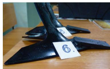
Рисунок 10 – Формирование в процессе эксплуатации искаженной геометрии носка лапы (а) и исправление дефекта в процессе восстановления (б)
