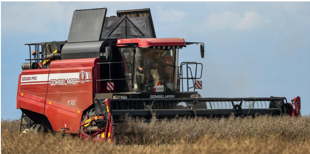
ванный соломоизмельчитель с 80-ю ножами и половоразбрасыватель. Вместительный зерновой бункер объемом 9,5 м<sup>3</sup> оснащен системой раздельной выгрузки зерна и вибродном. Использовано мощное светодиодное освещение рабочих зон.
