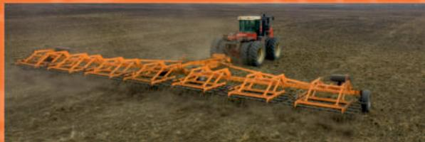
Предназначена для выравнивания поверхности полей, для рыхления верхнего слоя почвы на стерне на глубину до 50мм, удаления сорняков, разрушение почвенной корки и создание мульчирующего слоя.
