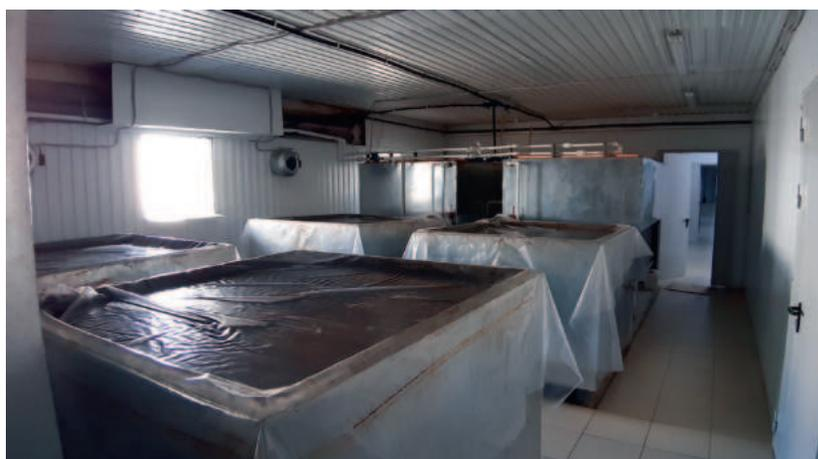
закрытым рабочим коридором с подводкой горячей воды (зимнее отопление) и холодной артезианской воды (летнее охлаждение).
