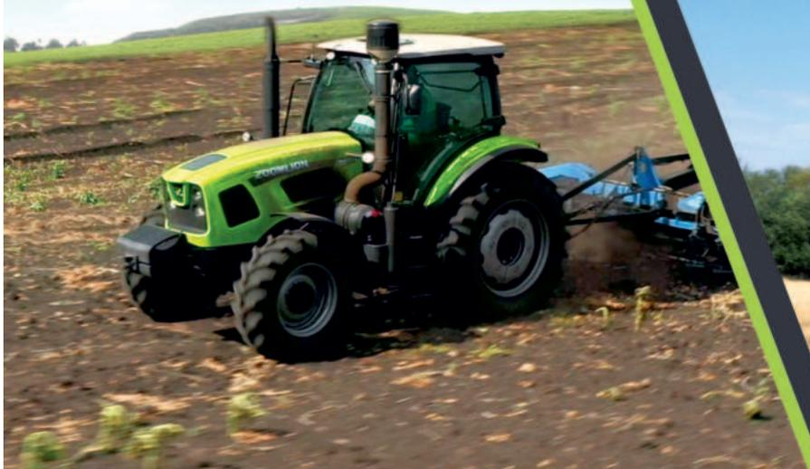
Двигатель - 4 цилиндра с системой впрыска топлива Common Rail, Турбонаддув, 4,837 л
