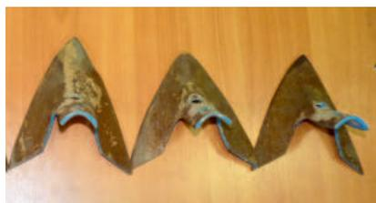
Рисунок 2 – Результат абразивного изнашивания долотообразных (а) и стрелчатых (б) лап культиваторов
