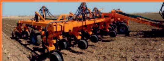
Для прямого посева; для посева по классической и минимальной технологиям. Предназначен для посева зерновых и масличных культур. Независимое копирование рельефа поля каждым сошником предоставляет возможность быстрой регулировки глубины посева по всем сошникам в диапазоне от 2 до 20 см.
