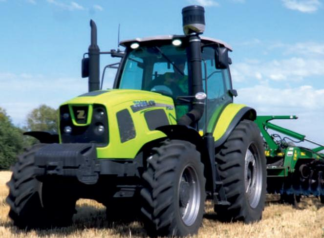
Двигатель - 4 цилиндра с системой впрыска топлива Common Rail, Турбонаддув, 4,837 л
