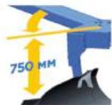
**Исключено забивание пожнивными остатками** за счет увеличенного расстояния от нижней плоскости корпусов до рамы (750 мм).
