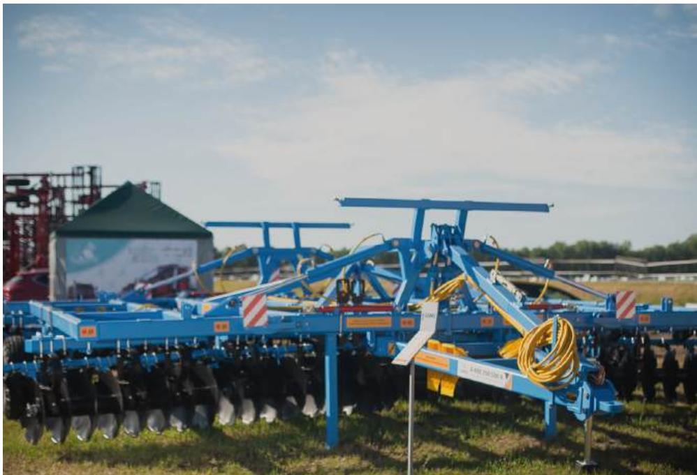
Тяжелая дисковая борона практически во всех сложных операциях будет ускорять работу. Она разделяет, измельчает и перемешивает слой растительных остатков, превращая его в органическое удобрение. Звезда легко справляется с задернелыми пластами и глыбами после вспашки, может измельчить пласты, поднятых кустарниково-болотными плугами.
