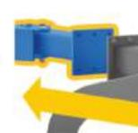
**С помощью дополнительных модулей 4-корпусные плуги ПОН переоборудуются в 5-корпусные, а 5-корпусные ППО в 6- и 7-корпусные.**
