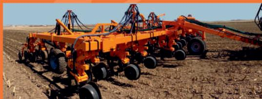
Для прямого посева, для посева по классической и минимальной технологии. Предназначен для посева зерновых и масляничных культур. Независимое копирование рельефа поля каждым сошником предоставляет возможность быстрой регулировки глубины посева по всем сошникам в диапазоне от 2 до 20 см.
