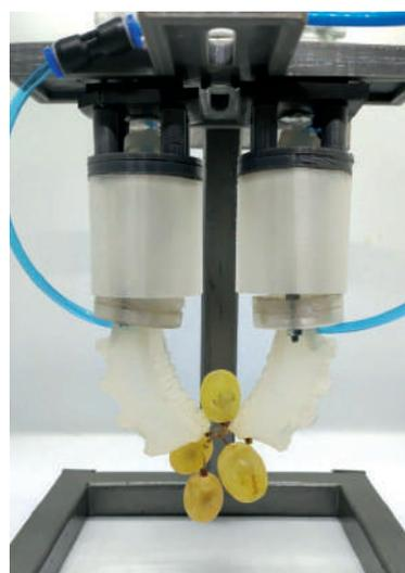
геометрической формы, подверженных повреждениям, в частности, плодов и овощей. Разрабатываемый захват представляет из себя «руку» с четырьмя модулями пальцев. Каждый из которых оснащен поворотным актуатором (приводом вращения). Принцип работы захвата основан на пневматике.
