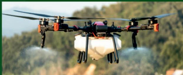
За счет возникающих при работе двигателей **турбулентных потоков**: капли рабочего раствора имеют возможность попадать на **труднодоступные** участки растения — нижний ярус листьев и нижняя поверхность листьев, что приводит к тому, что более **высокий процент рабочего раствора** попадает на само растение.
