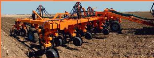
Для прямого посева, для посева по классической и минимальной технологии. Предназначен для посева зерновых и масличных культур. Независимое копирование рельефа поля каждым сошником предоставляет возможность быстрой регулировки глубины посева по всем сошникам в диапазоне от 2 до 20 см.
